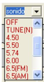
Mediante la selección de esta opción, tendremos la posibilidad de configurar las opciones de sonido, bien sea para efectuar demodulaciones AM, FM, para seleccionar un offset determinado entre portadora de video y audio, para seleccionar la frecuencia deseada de recepción de audio, o bien decodificación de audio NICAM. A modo de resumen se muestra la siguiente tabla:
