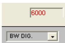
Para poder medir potencia, así como la relación portadora/ruido en canales digitales, es necesario definir previamente el ancho de banda del canal digital. El ancho de banda se representará en KHz. Para su configuración disponemos de un cuadro de texto, donde introduciremos el valor deseado de ancho de banda de medida en KHz, para nuestro canal, y a continuación para que se haga efectivo se pulsará retorno de carro, para que sea enviado el comando CW correspondiente.
