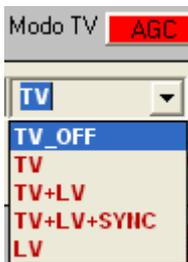
Se dispone de un combo para seleccionar el modo de funcionamiento como televisor, en él el monitor del Prolink-7, puede actuar como indicador analógico de nivel, como analizador de espectros y permite visualizar la señal de sincronismo de línea, como se vería en la pantalla de un osciloscopio.
