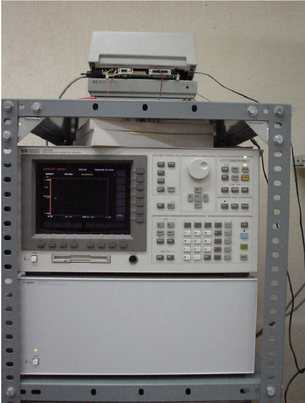
Figura 5.1. Trazador de curvas Hewlett Packard 4155-A.
