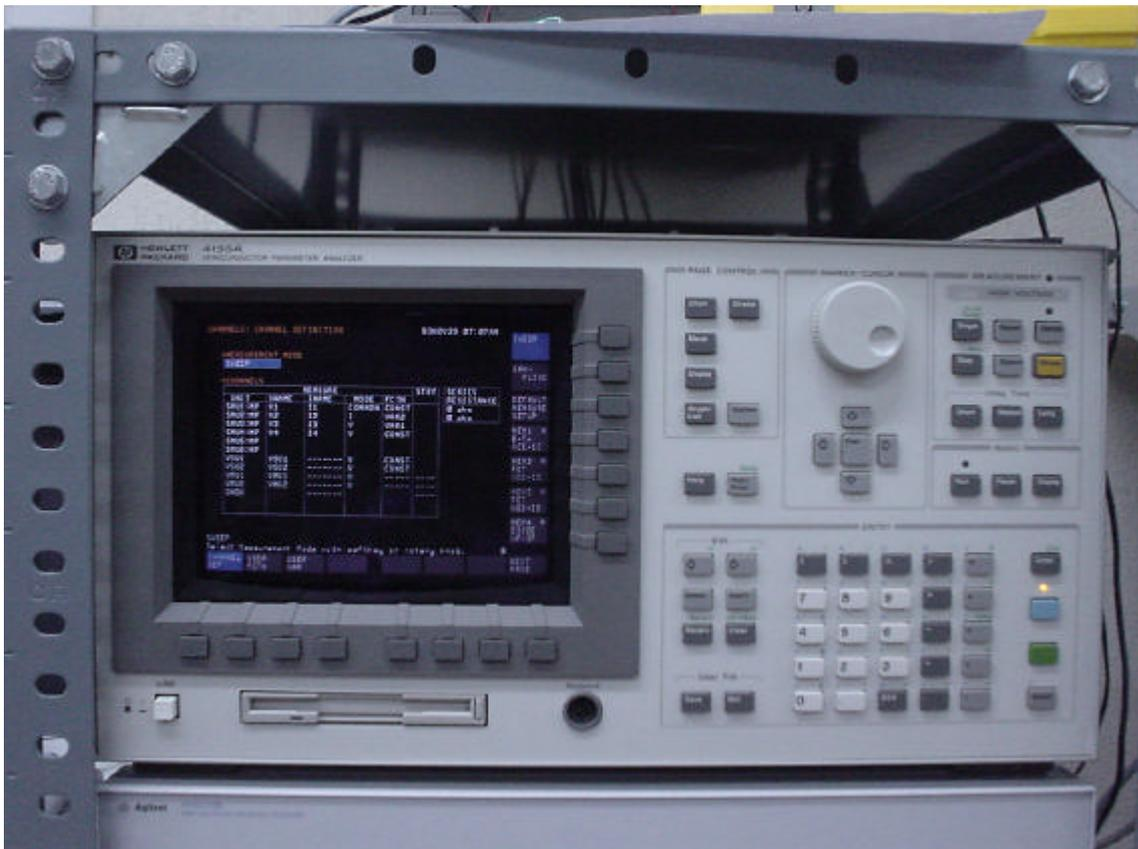
**Figura 5.3. Frontal del trazador de curvas 4155A de Hewlett Packard. Podemos observar los distintos botones del instrumento, así como su pantalla.**
