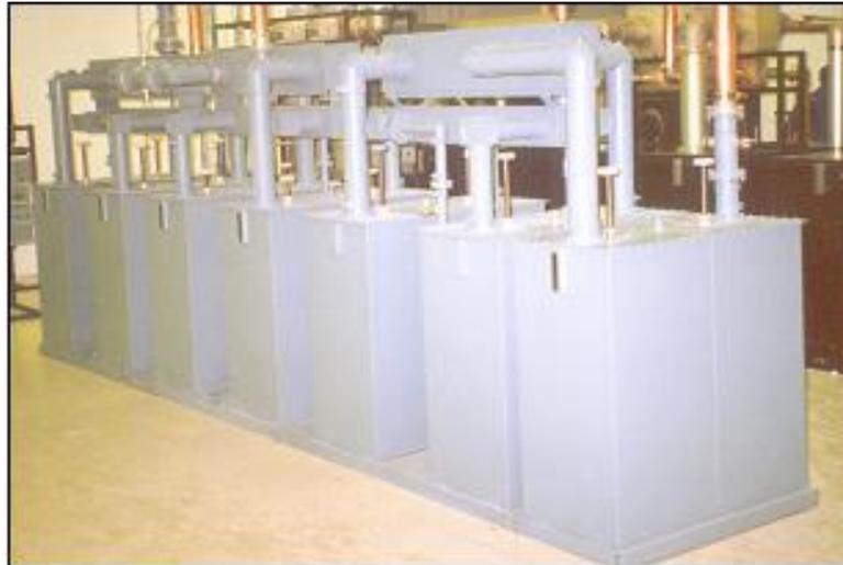
**Figura 2.2: Multiplexor de FM en funcionamiento.**
