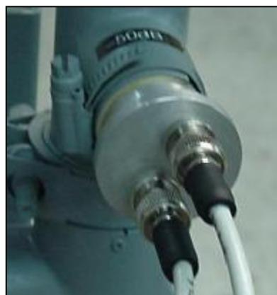
**Figura 2.4: Sonda de 50dB de atenuación, conectada a sensores de Potencia.**
