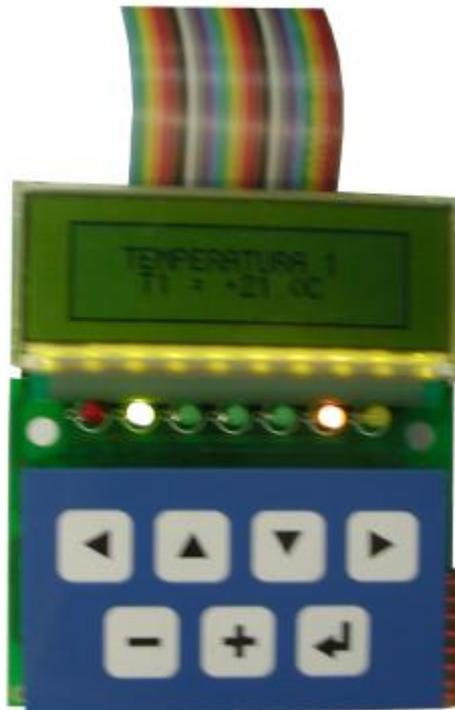
**Figura 5.4: Display mostrando una sub-pantalla para el Termopar 1.**
