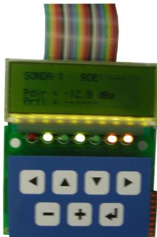
**Figura 5.3: Display mostrando una sub-pantalla para la Sonda 1 con problemas en la potencia reflejada.**
