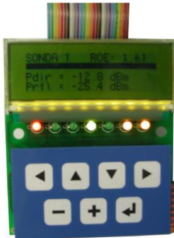
**Figura 5.2: Display mostrando una sub-pantalla para la Sonda 1.**
