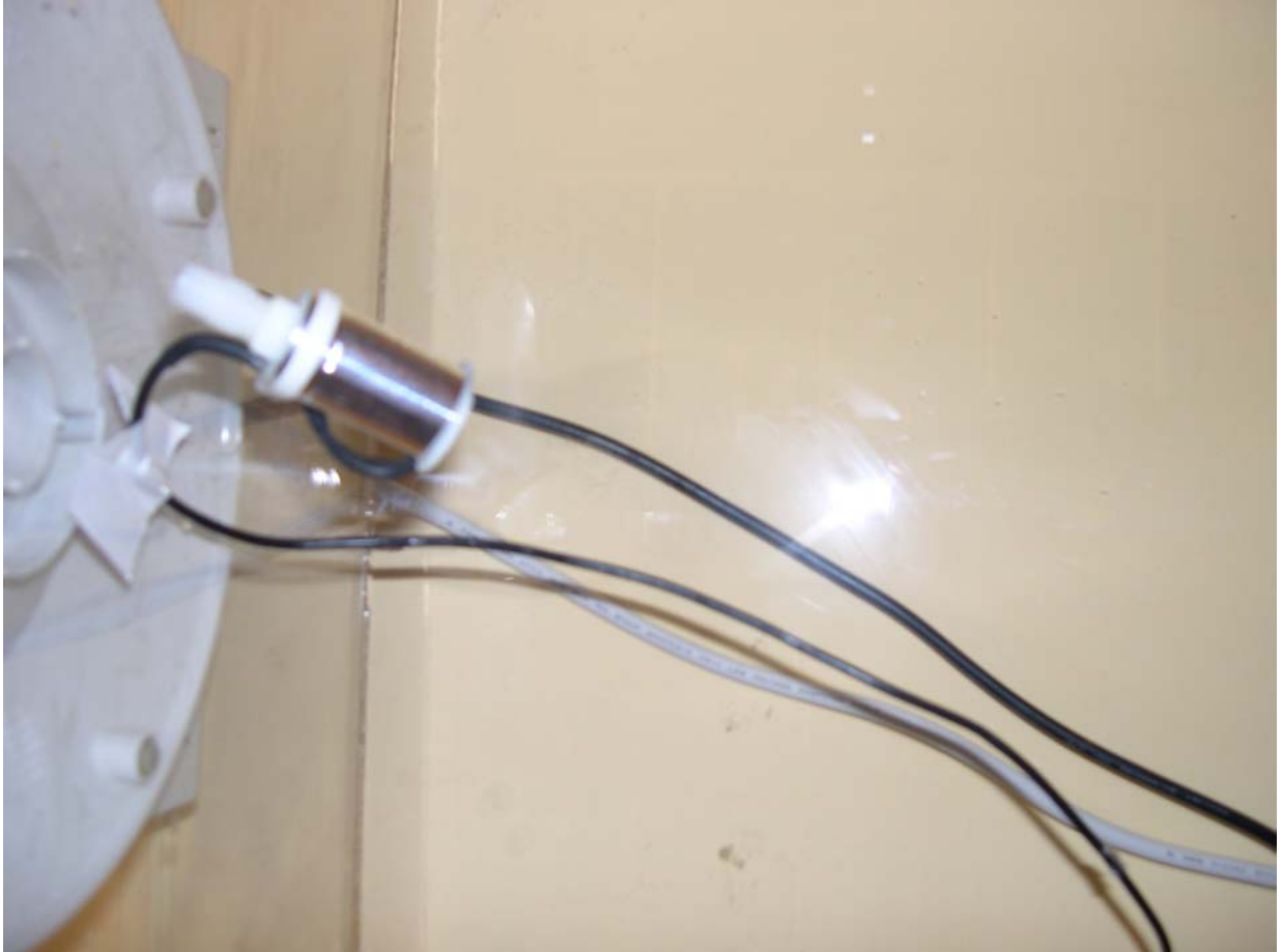
Figura 3.2. Sensor de oxígeno
