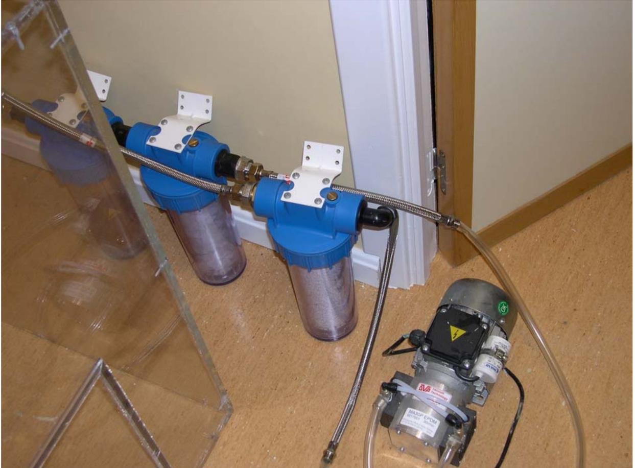
**Figura 3.22.** *Circuito de limpieza del aire*
