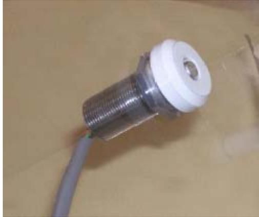
**Figura 3.6.** *Sensor de temperatura*
