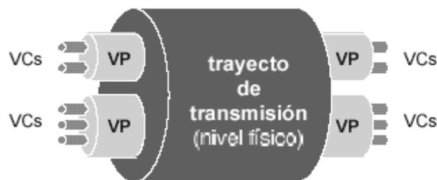
FIGURA 2.2: TIPOS DE CONEXIONES ATM
