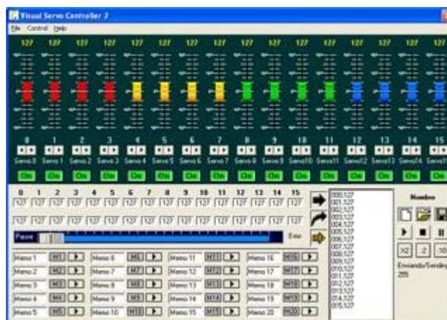
Visual Servo Controlador 2 es un programa para controlar servos mediante los circuitos controladores de servo Mini SSC II (**S310165 Controlador 8 Servos SCC**) y compatibles, así como el nuevo SSC -12 canales (**S310170 Controlador de 12 Servos**). El programa se caracteriza por su facilidad de manejo, permitiendo controlar hasta un máximo de 16 servos de una forma sencilla e intuitiva gracias a su interfaz gráfica.
