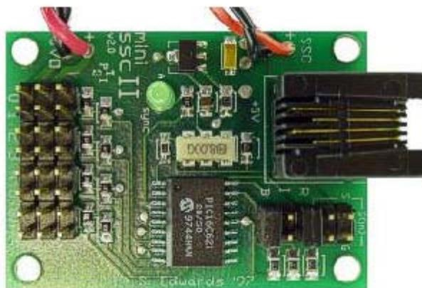
Figura 2.4.8.- Tarjeta controladora MINI SSC S310165
