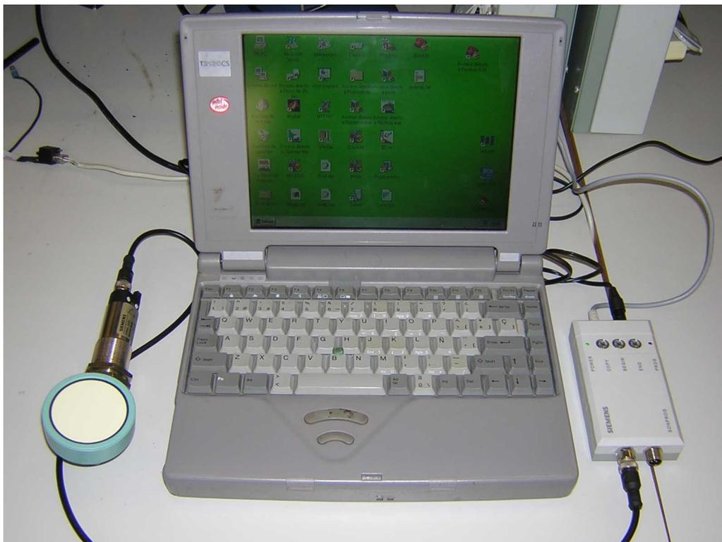
Figura 2.13: Conexión del sonar al ordenador por medio de la interfaz 3RX3000
