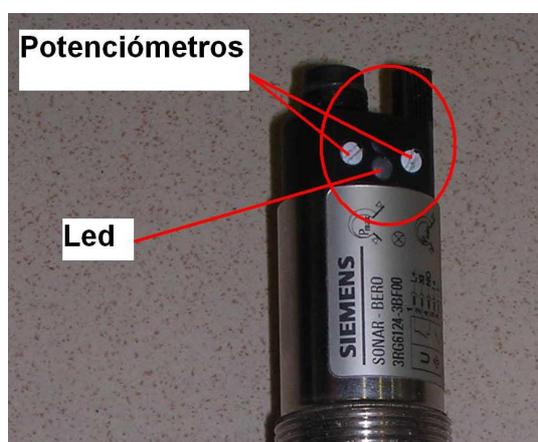
Figura 2.11: Detalle de los potenciómetros y el led de los sonares
