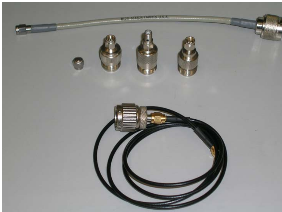
Figura 5.9. Cables y adaptadores coaxiales.
