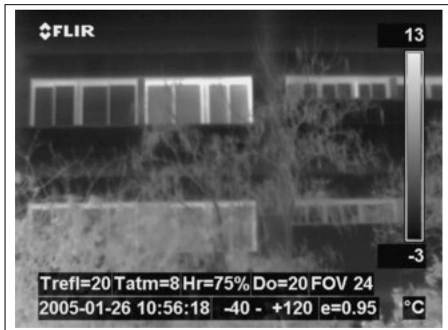
**Figura 4.2:** Imagen tomada a 20 metros. Posición frontal.  $\rho=0.95$
