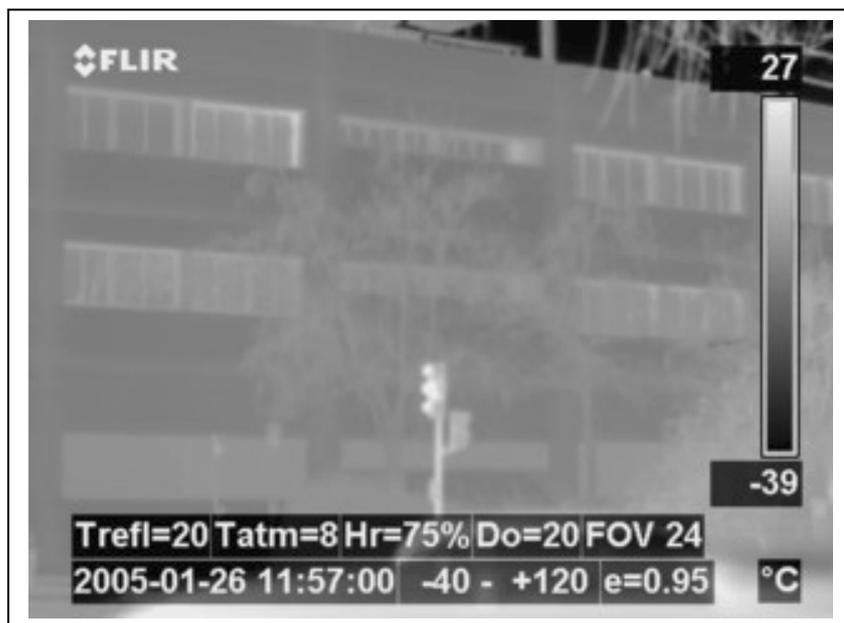
**Figura 4.8:** Imagen tomada a 20 metros. Formando ángulo  $\sim 30^\circ$ .  $\rho=0.99$
