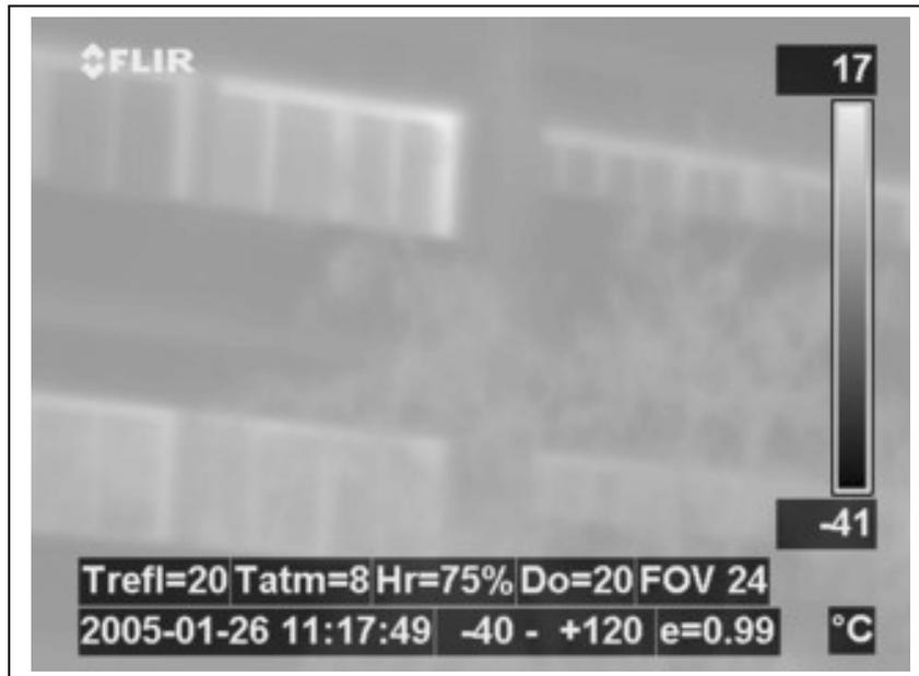
**Figura 4.5:** Imagen tomada a 20 metros. Formando ángulo  $\sim 30^\circ$ .  $\rho=0.99$
