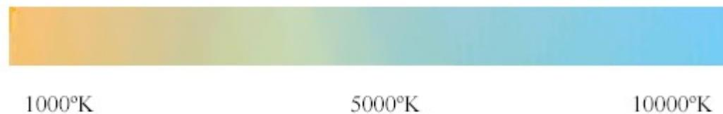
**Figura 2.5:** Temperatura de color según el calentamiento del 'cuerpo negro'.
