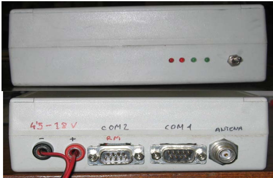
Imagen 2.6 : Vista dorsal y frontal del receptor RT-2
