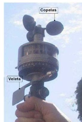
**Ilustración 5: Anemómetro de copelas**
