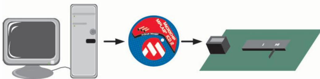
Figura 2.9 Esquema de conexionado para programación y depuración
