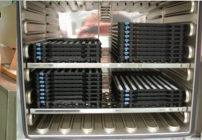
Fig. 28: Bandejas con sensores en el horno
