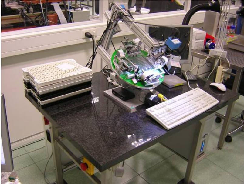
Fig. 25: Estación de medida inclinada para test eléctrico del NS-25/C2
