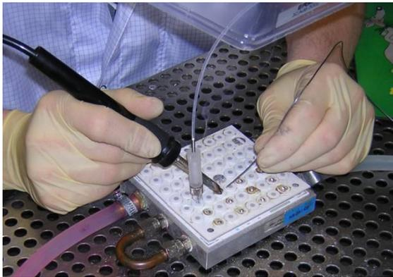
En una de las dos estaciones preparadas para tal propósito se coloca el plato sobre una base refrigerada por agua y se rellena el sensor con la bomba de llenado que proporciona 85 ml de electrolítico al presionar un pulsador de pie y acto seguido se suelda el orificio de llenado con SnPb5Ag2.5
