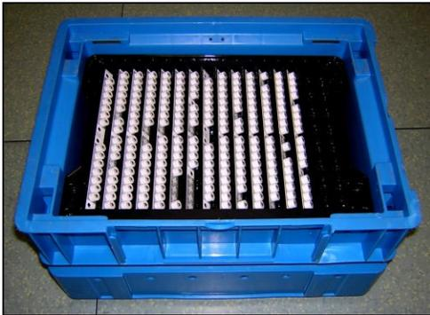
Se envían los sensores a otra empresa para el último paso de la fabricación, que consiste en ensamblar los pines al sensor.
