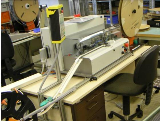
Fig. 20: Máquina semiautomática para ensamblaje de pines
