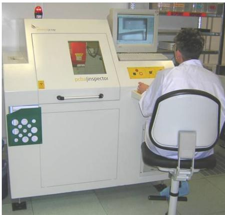
Se realiza una radiografía de cada sensor y se comprueba ópticamente que no haya ningún defecto en la soldadura. Cualquier error en la soldadura nos llevaría a desechar el sensor para prevenir futuros problemas al usarlos.
