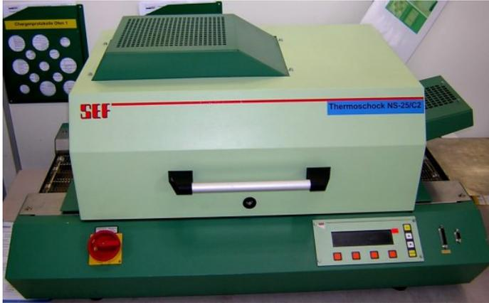
Se introducen las filas de sensores en un horno provisto de una cinta continua y se calientan hasta 350 grados para fijar la tinta.
