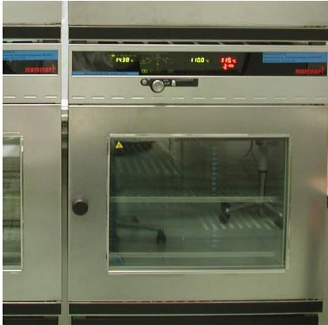
Fig. 27: Máquina para almacenamiento a alta Tª
