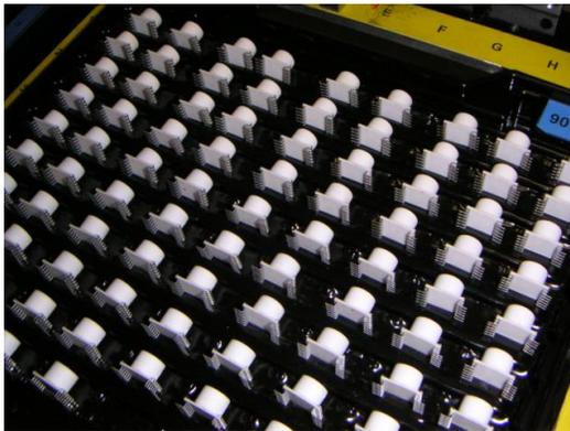
Fig. 33: Sensores NS-25/C2 girados en la bandeja
