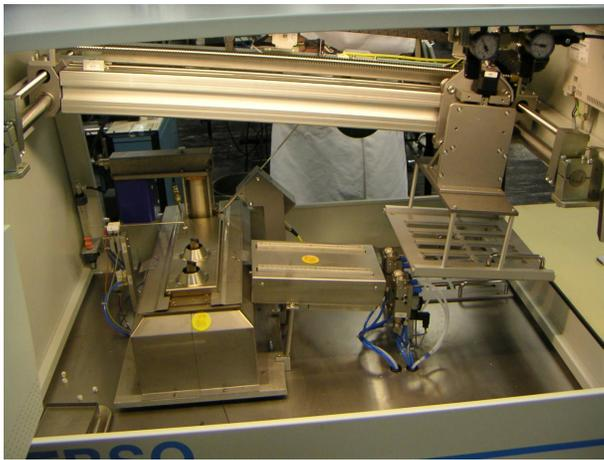
Fig. 21: Máquina para soldar los pines
