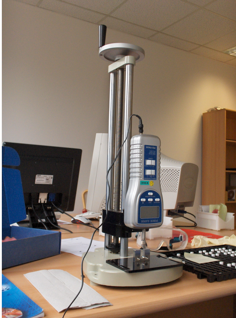
Figura 73: Sistema de medición de la estabilidad mecánica
