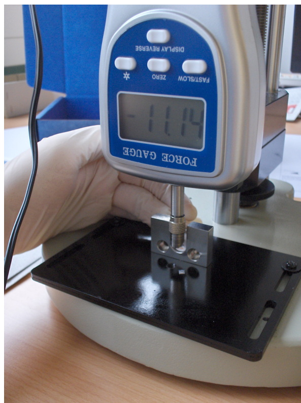
Figura 75: Sensor con la tapa desprendida y medida en kp
