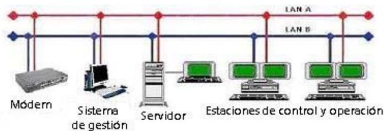
**Figura 1: Configuración típica de SCADA**
