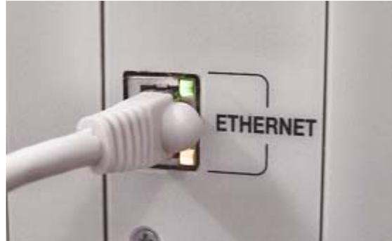
La transmisión de datos se realiza en banda base, con una velocidad mínima de 10 Mbits por segundo, para lo cual se necesita tecnología 10BaseF y por tanto adaptadores Ethernet que soporten esa velocidad, como el de la figura 14, modelo CS1D-ETN21D de Omron. El protocolo de red utilizado es Modbus Ethernet TCP/IP.
