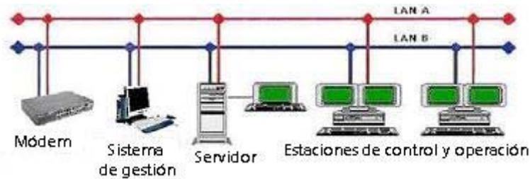
**Figura 1: Configuración típica de SCADA**
