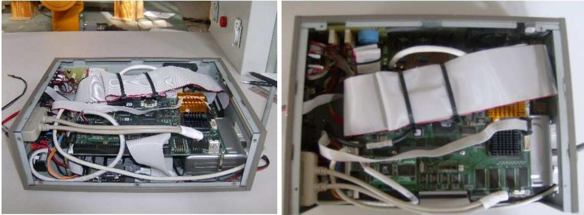
Figura 5.2: Vistas de la caja aviónica sin la carcasa superior.
