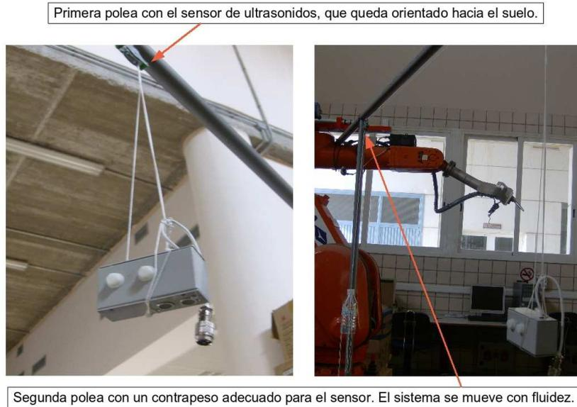
Primera polea con el sensor de ultrasonidos, que queda orientado hacia el suelo.
