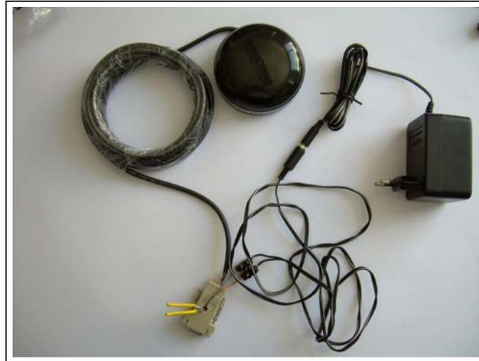
Figura 26: Conexión del GPS al transformador
