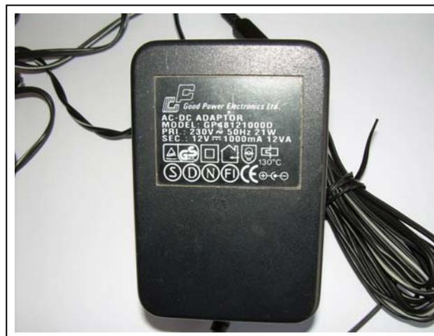
Figura 25: Transformador empleado para la alimentación del GPS
