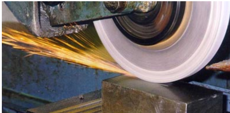
Figura 1.1: Rectificado de metal, herramienta y formación de chispas.
