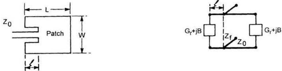
Figura 2.20. Alimentador por línea microstrip introducida en el parche
