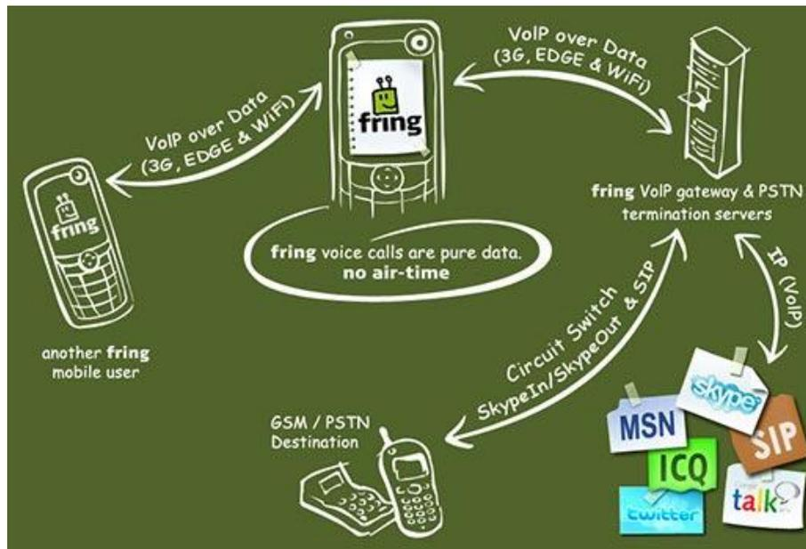
Figura 40. Funcionamiento de Fring.
