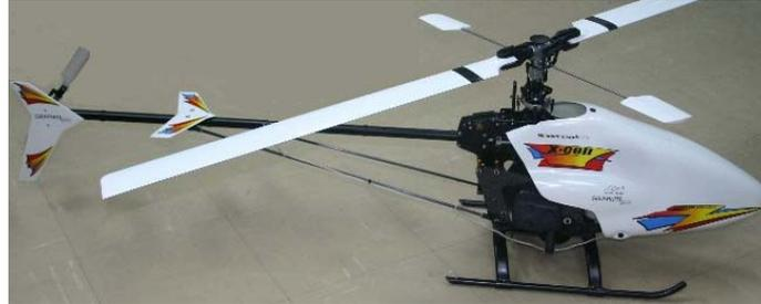
**Figura 3.9: Modelo de helicóptero X-Cell 0.60 usado en el proyecto Colibrí de la universidad EAFIT**
