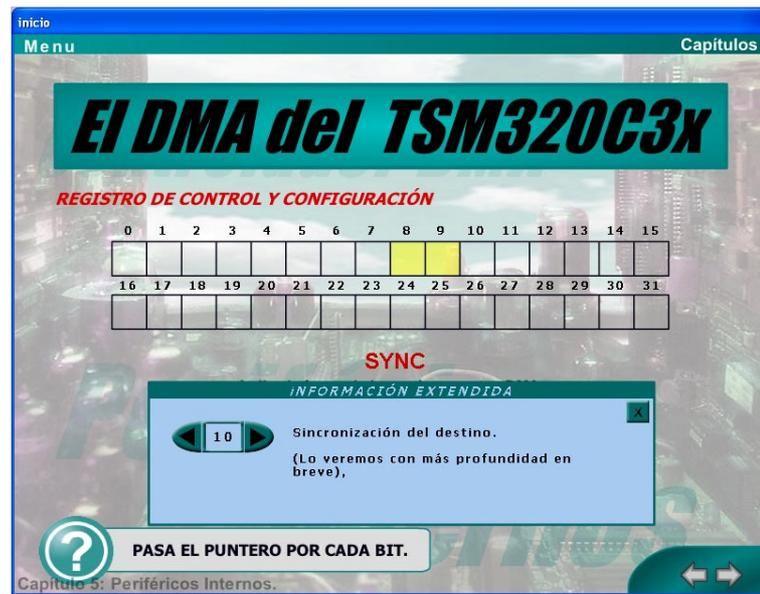
Fig. 5.10. Registros de configuración del periférico DMA..
