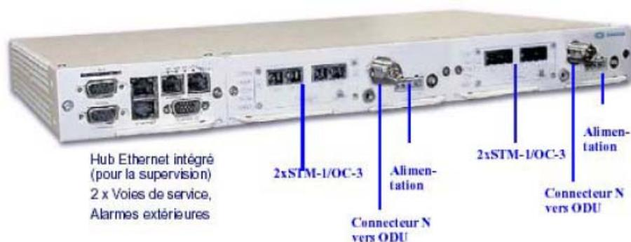
La cara delantera del equipo SAGEM LINK A presenta 2 entradas Ethernet para la supervisión, un acceso para la vía de servicio, el conector de alarmas y un conector para el cable de protección.
