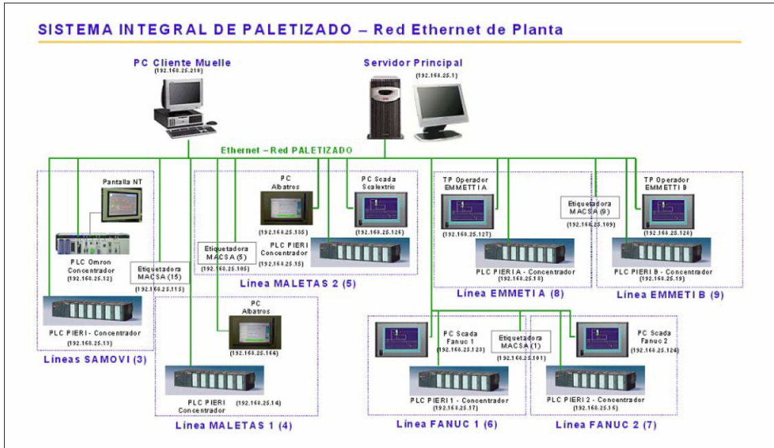
Figura 4.8: Arquitectura final del Sistema Integral de Paletizado
