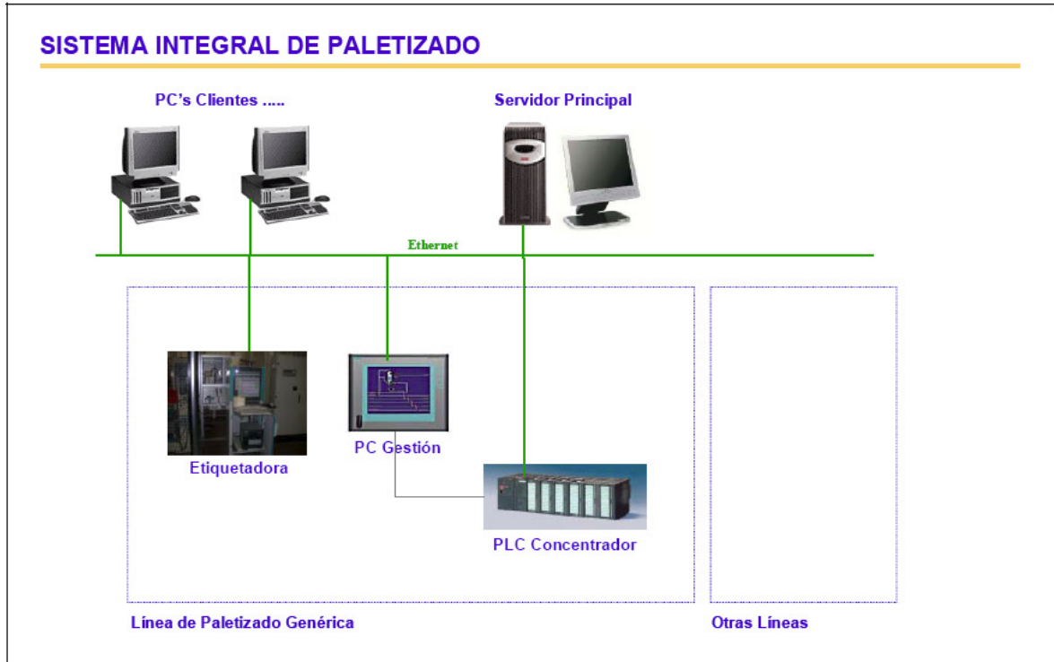
Figura 4.1: Arquitectura global del Sistema Integral de Paletizado
