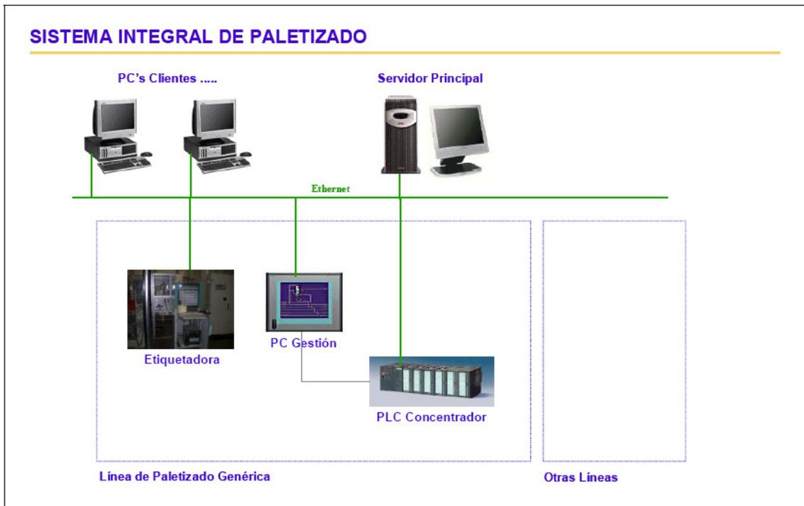
Figura 6.1: Arquitectura global del Sistema Integral de Paletizado
