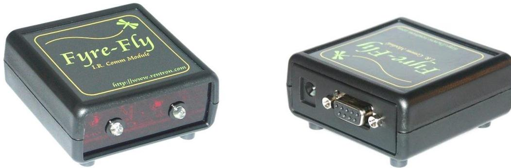
Figura 3.1 Imágenes frontal y trasera del transceptor Fyre-Fly
