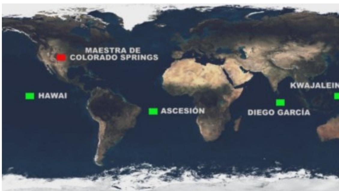
**Figura 4. Estaciones de control de la constelación NAVSTAR**
