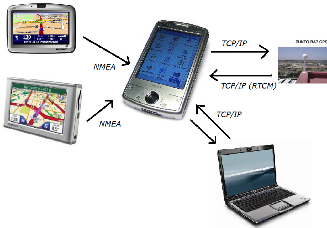
Figura 1. Diagrama de flujo de funcionamiento del proyecto
