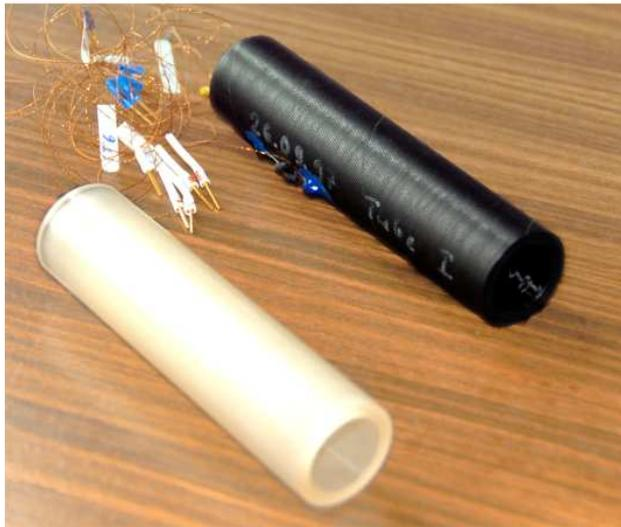
Figura 2.3: Tubo de fibra de carbono reforzado de plástico y tubo de Zerodur™ de clase cero. Tubos sumamente estables térmicamente diseñados específicamente para la medida del coeficiente de expansión térmica usando el prototipo dilatómetro óptico con el que se ha trabajado en este proyecto.
