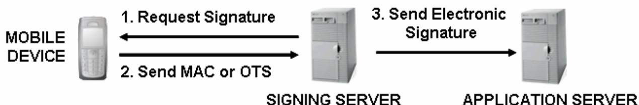
Figura 2.7. Proceso de firma electrónica generada en un servidor
