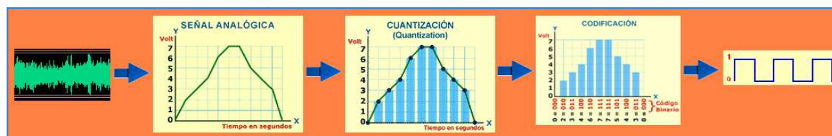
Figura 2.2.2: Etapas de conversión de la señal analógica
