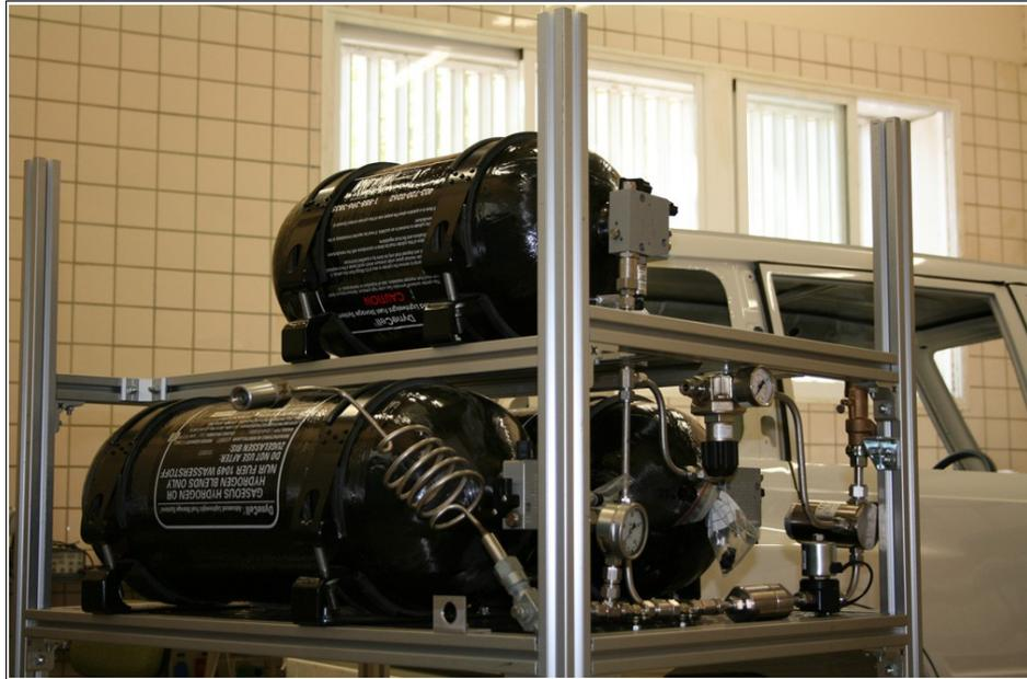
Imagen 33: fotografía de los depósitos de hidrógeno
