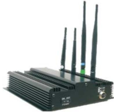
Figura 2. Inhibidor de frecuencia.
