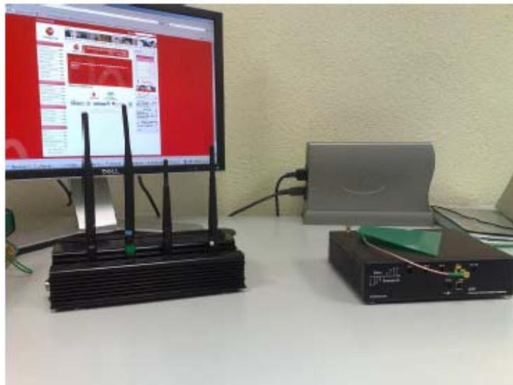
Figura 34. Imagen del inhibidor y el detector usados en las pruebas.
