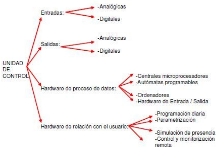
Figura 6.2: Composición de la unidad de control
