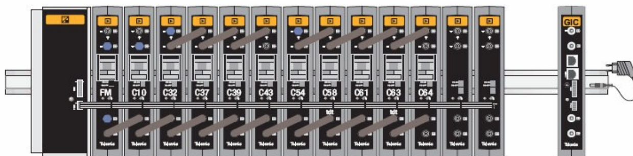
Figura 6.6: Conexión del GIC al equipamiento de cabecera
