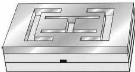
**Figura 3.16: Dipolo plegado impreso simétrico.**
