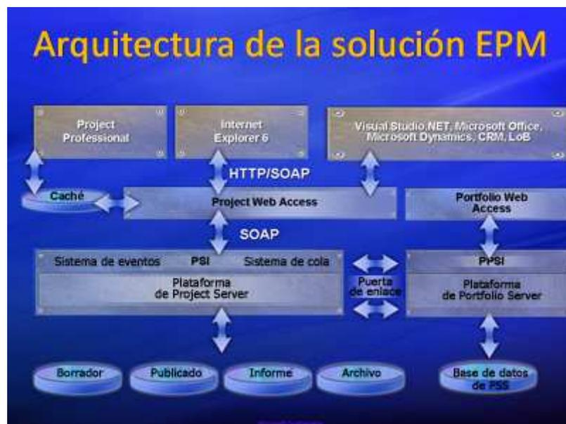
Ilustración 50: Diagrama de bloques de la arquitectura de EPM Microsoft, extraída de [11]
