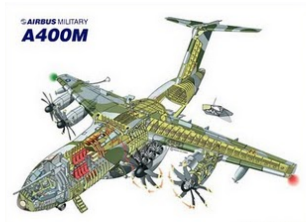
Figura 3.1: Imagen general de los componentes del A400M
