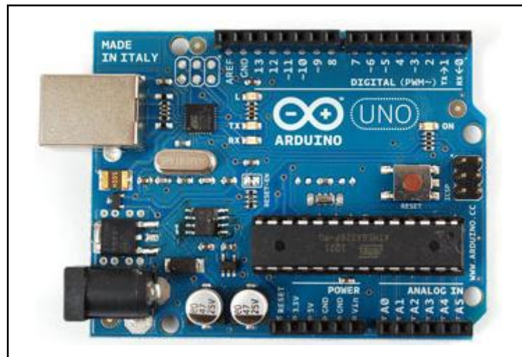
Figura 12. Parte delantera de la placa ARDUINO UNO R3.
