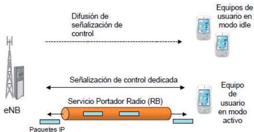
Figura 2.3. Mecanismos de transferencia de la información en el canal radio
