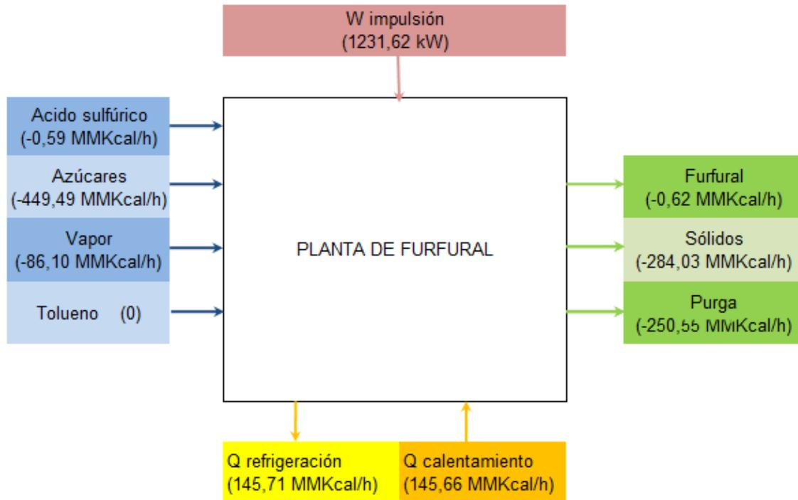
**Figura 4.24.** Balance de energía
