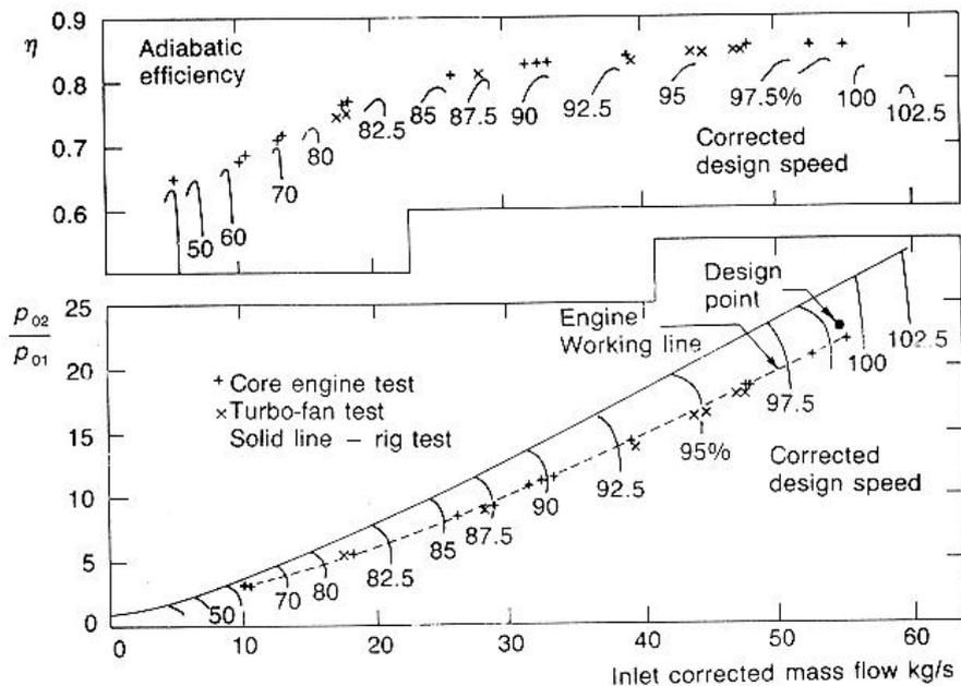
Figura 3.4 : Curvas generalizadas del compresor axial E3.
