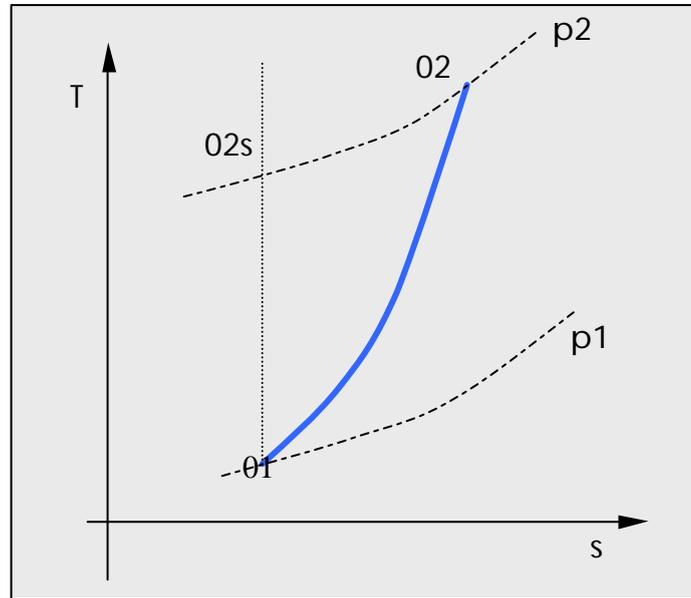
Figura 3.5 : Diagrama T\_s del proceso en el compresor.
