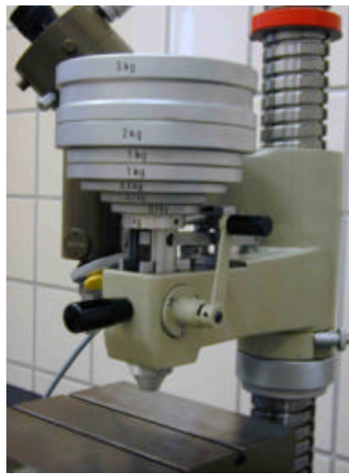
Figura 4.2. Sistema de pesas para cargas entre 200 g y 10 kg.
