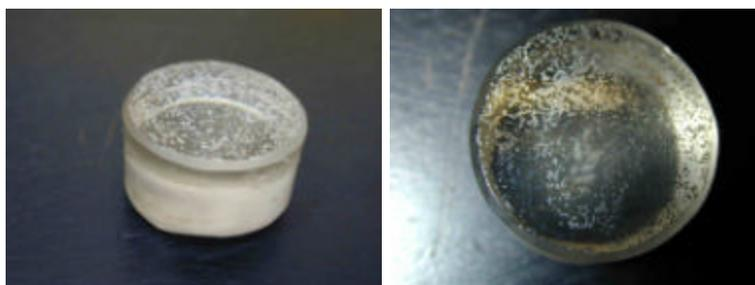
Figura 5.2. Vistas de una probeta de partículas de polvo metálico empastillados en resina de poliéster.
