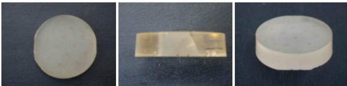
Figura 5.3. Diferentes vistas de una probeta de resina de poliéster.
