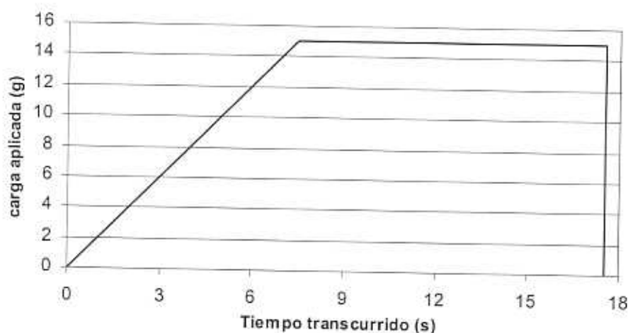
Figura 6.16. Evolución de la carga aplicada en el microdurómetro NIKON MHT-4, una vez contactan penetrador y probeta.
